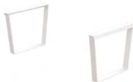
Gambe in piatto di acciaio a sezione 50×6 mm, piegato ad anello, con con saldate nella parte superiore piastre in lamiera di acciaio decapata spessore 3 mm. Dotate di feltrinini antiscivolo.
